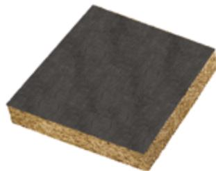
Wärmedämmende Beplankungsplatte mit luftdichter Bitumenbarriere. Sie schützt Häuser mit Holzrahmenkonstruktion vor Wärmeverlust durch Luftzug und vor Eindringen atmosphärischer Feuchtigkeit in den Innenraum. Sie ist vor allem an feuchten Stellen mit kaltem Klima zu empfehlen.
